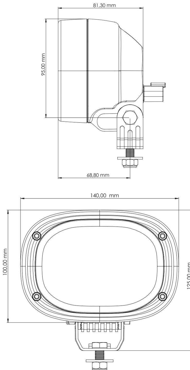
Esta luz de trabajo puede usarse para proporcionar luz utilizable en máquinas de superficie o subterráneas. La opción de carcasa amortiguada contra vibraciones puede extender la vida útil de la bombilla y, junto con el revestimiento resistente a la corrosión, asegura que esta luz soporte los entornos más duros. La luz halógena 1014 está disponible con la opción adicional de montaje lateral, lo que permite instalar esta luz de trabajo en una multitud de ubicaciones.
